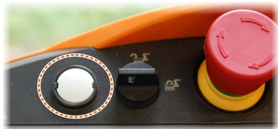
图 3-43: 用于脱开 smartPAD 的按钮
