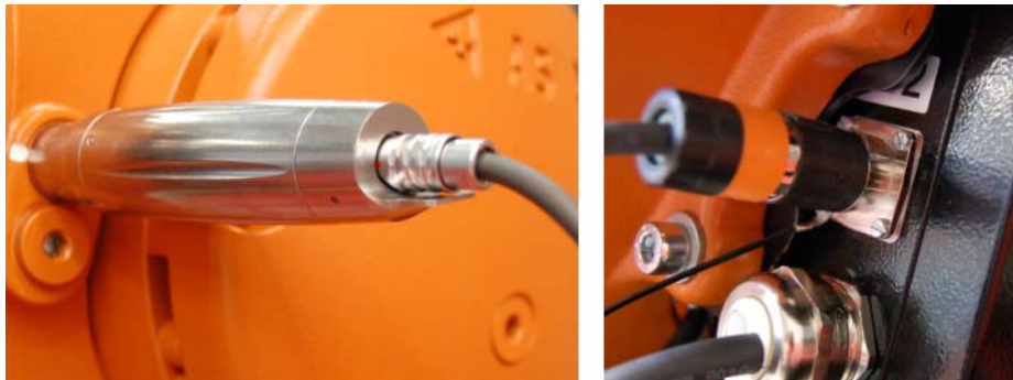
图 3-8: EMD 电缆，连接
