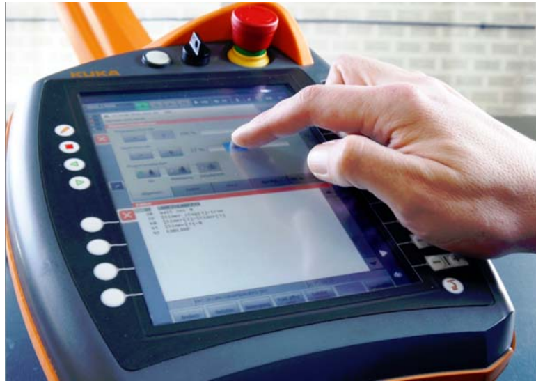
图 1-10: 可利用库卡 smartPAD 进行机器人编程
