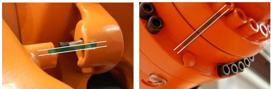
图 3-6: 预零点标定位置示例
