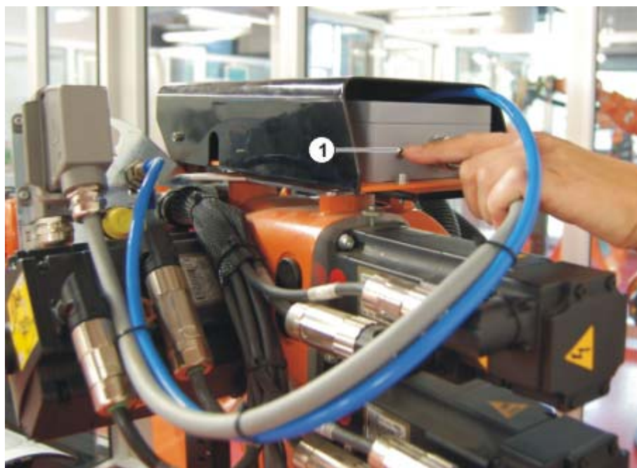
图 3-23: 碰撞保险装置的撤回开关
