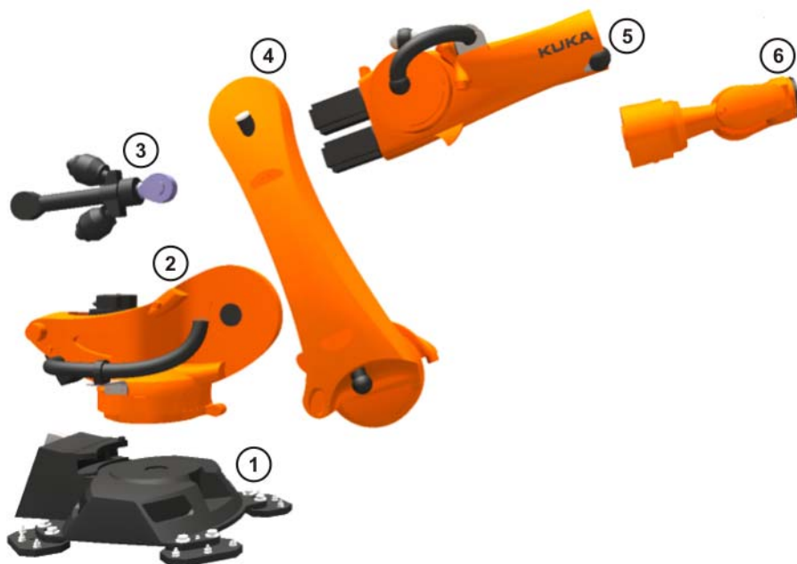
图 1-3: 机器人的机械零部件概览
